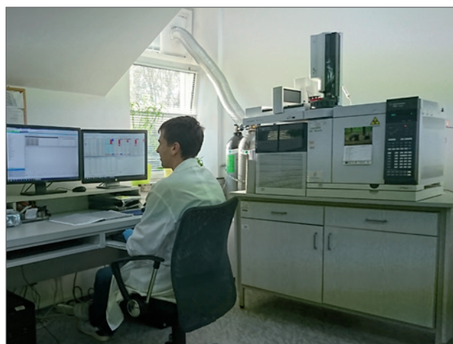
Chromatograf gazowy Agilent 7000C GC-MS do oznaczeń substancji priorytetowych Fot. M. Hać
