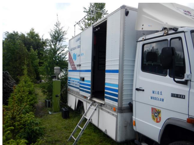
Fot.1. Mobilna stacja pomiarowa i pobornik pyłu PM 10 w Czarnym Lesie
