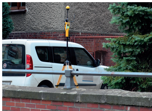
Punkt pomiaru poziomu pól elektromagnetycznych
