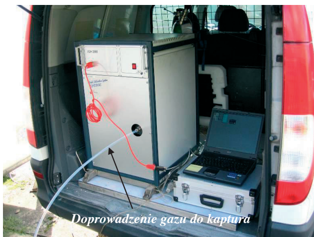
Fot. 1.3.4. Badanie efektywności układu poboru prób - układ rozcieńczania
