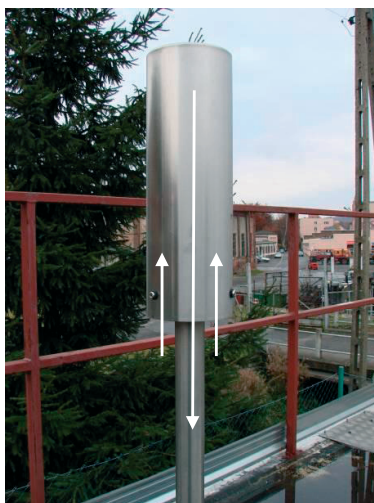
Fot. 1.3.2. Zabezpieczenie wlotu powietrza do układu poboru prób
