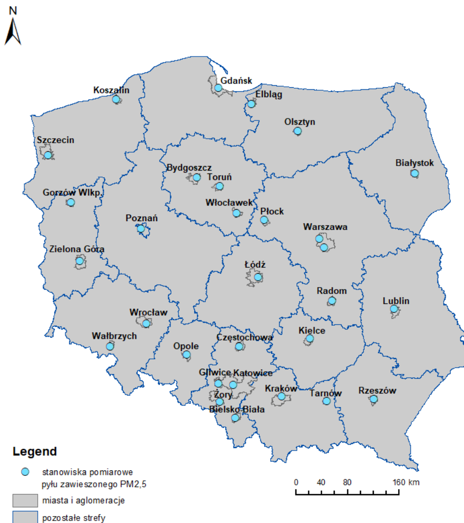
Rysunek 1. Lokalizacja stanowisk pomiarowych, w których prowadzono pomiary stężenia pyłu zawieszonego PM 2,5 na potrzeby obliczenia krajowego wskaźnika średniego narażenia dla roku 2021 [źródło: GIOŚ]
