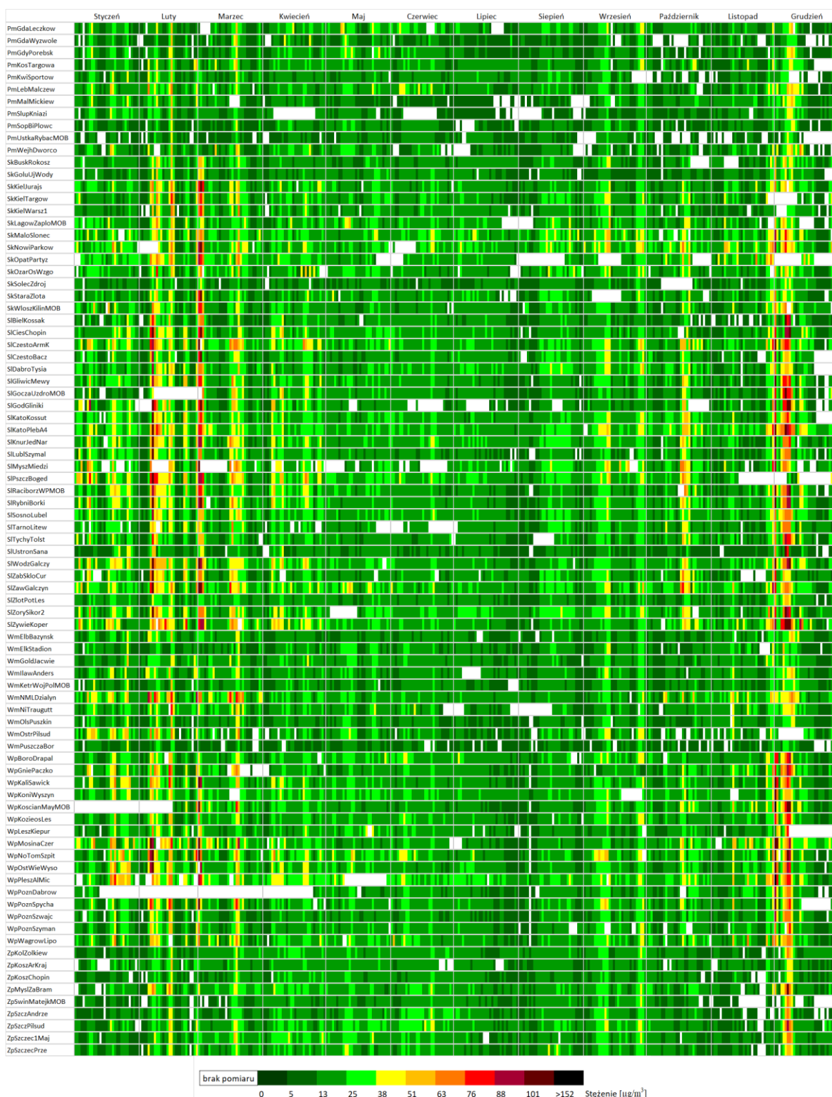
Rys. 6-10c. Zmiany stężeń średnich dobowych na stacjach pomiarowych pyłu zawieszonego PM10 w 2023 r.
