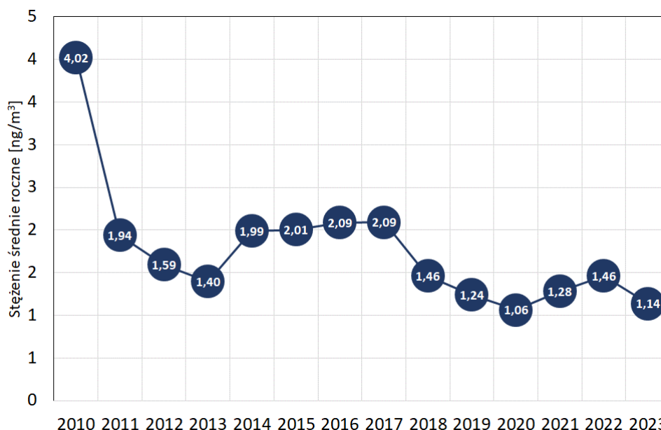
Rys. 8-4. Zmiany stężeń średnich rocznych arsenu As oznaczanego w pyłach zawieszonym PM 10 w Polsce w okresie 2010-2023
