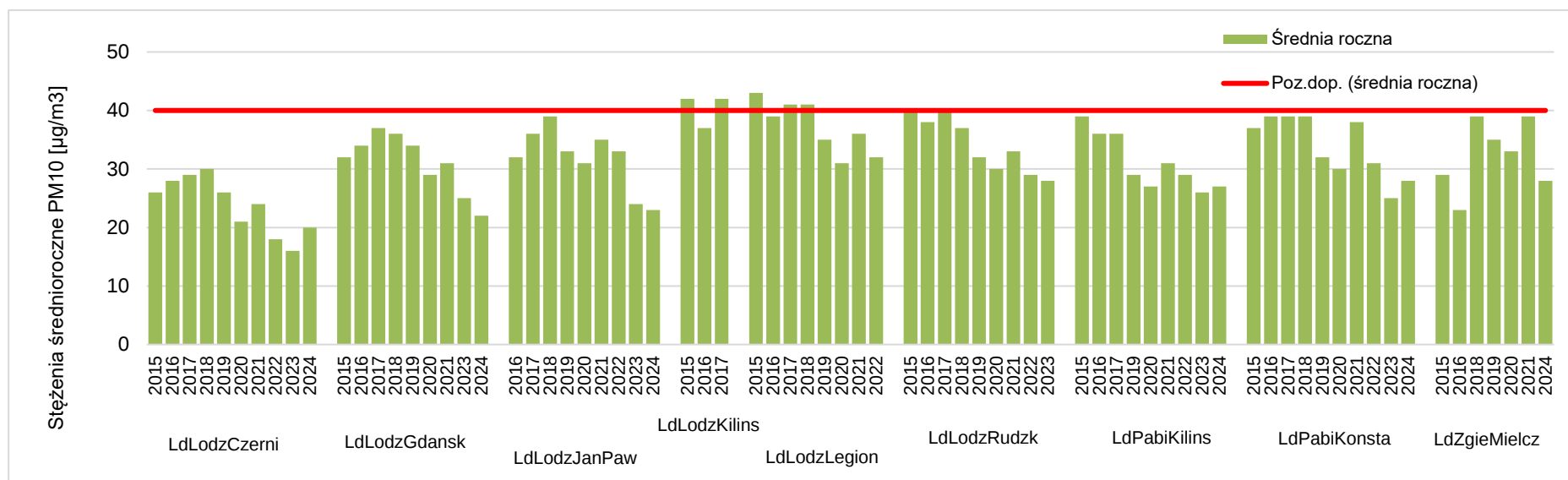
Rysunek 7.30. Przebieg wartości średniej rocznej stężenia pyłu zawieszonego PM10 na poszczególnych stanowiskach pomiarowych w województwie łódzkim, na tle poziomu dopuszczalnego w latach 2015 – 2024 (strefa oceny aglomeracja łódzka) [źródło: GIOŚ]
